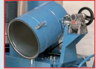
Metal talaşların kolay boşaltılmasını sağlayan hazne (model 450 - 700)
